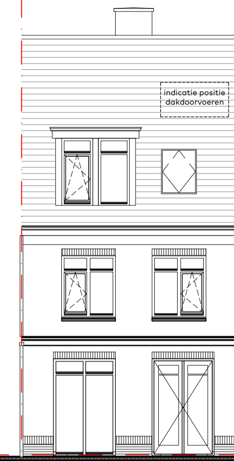
optie E1-04 dakraam achterzijde
